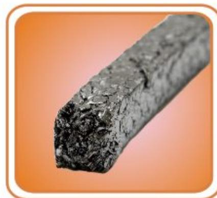
**ПГН 3400-1** плетеная на основе терморасширенного графита, армированная металлической проволокой (набивка в сборе оплетена металлической сеткой)
